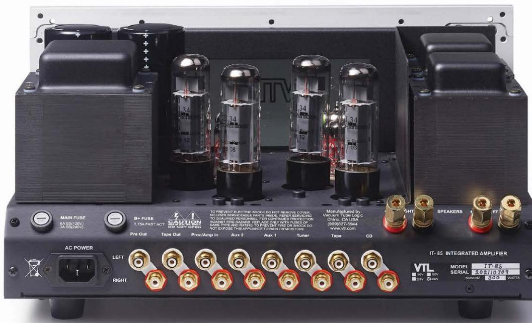
**Für stereophone und mehrkanalige Anwendungen gerüstet: Der IT-85 verfügt über einen AV-Prozessor-Eingang, an seinen Vorstufenausgang kann auch ein Subwoofer angeschlossen werden (Foto: VTL)**
